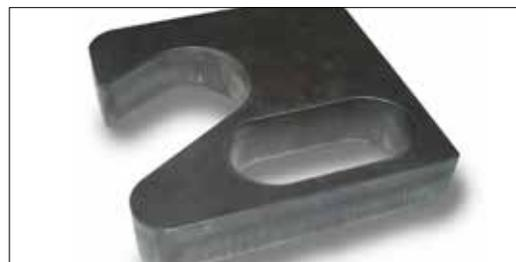
*Ejemplo de corte Acero al carbono de 20 mm con aire/aire*
