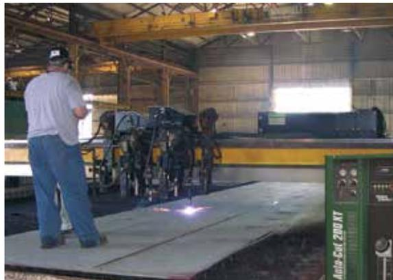
*Ejemplo de corte con el sistema WMS*
