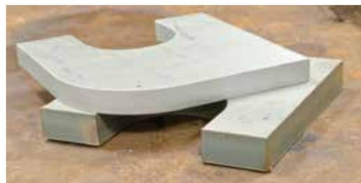
*Ejemplo de corte al aluminio de 15 mm y acero inoxidable de 20 mm*
